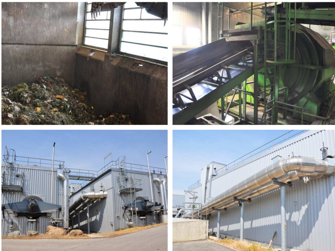
Obr. 4: Technologie KOMPOGAS - nevytříděný vstupní materiál (vlevo nahoře), třídící linka (vpravo nahoře), Horizontální fermentory s míchadly (vlevo a vpravo dole)
