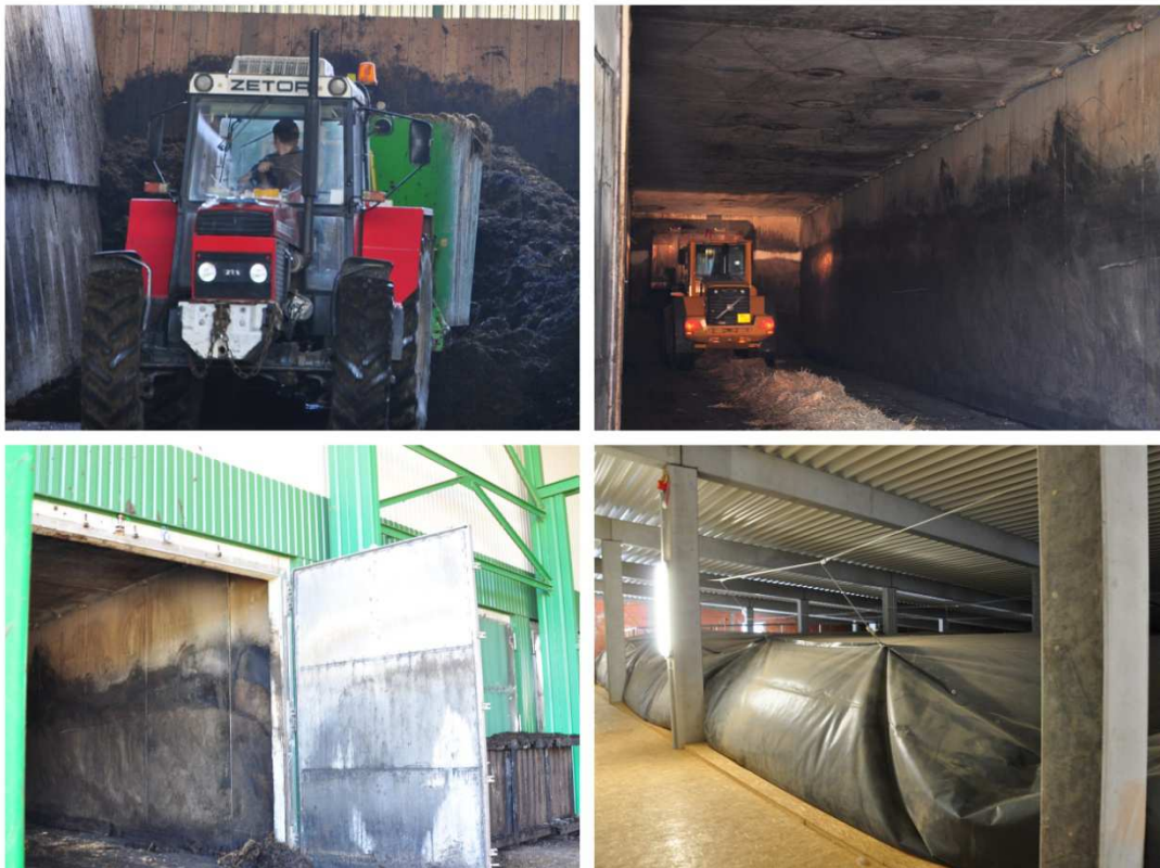
Obr. 3: Technologie BIOFERM: míchání substrátu (vlevo nahoře), navážení substrátu do reaktoru (vpravo nahoře), vzduchotěsná vrata reaktoru v pozadí další reaktor (vlevo dole), plynový vak (vpravo dole)
