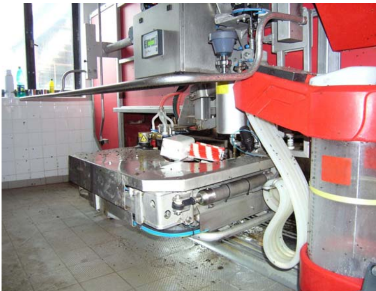
Obr. 1 Příklad dojící robotizované soustavy
