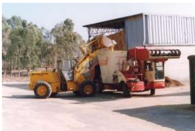
Příprava krmné dávky v míchacích krmných vozech umožňuje celý proces krmení skotu přesně řídit a mechanizovat
