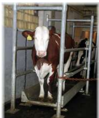
Hmotnost dojnic byla sledována automatickou tenzometrickou průchozí vahou u východu z dojírny
