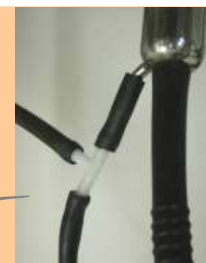
obr. 4 Připojení T-kusu pro měření podtlaku v pulzační komoře
