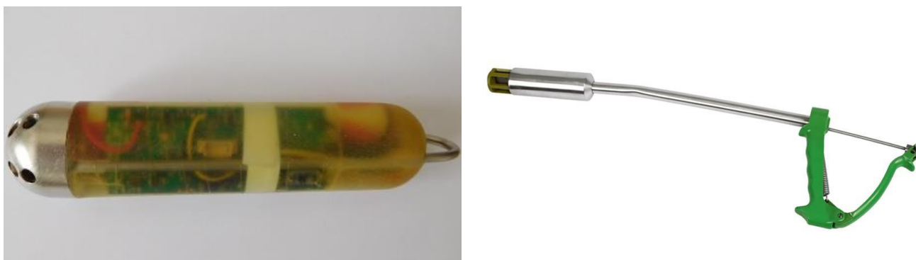
Obr. 8: Obrázek bolusu eCOW (vlevo) a aplikátoru (vpravo)
