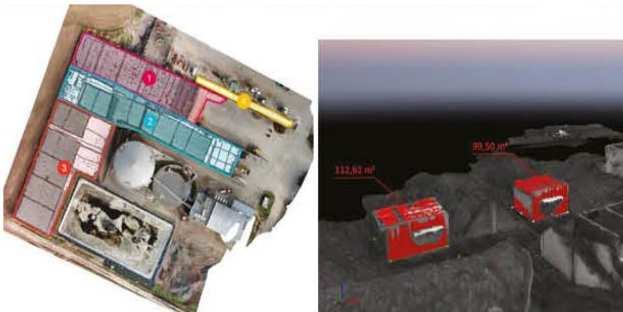
Obr. 3: Snímek areálu skladů krmiv (vlevo) a snímek z 3D projekce objemu krmiva (vpravo)
