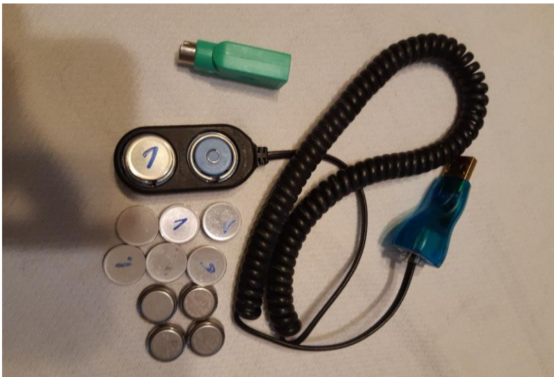
Obr. 5: Snímek bateriového teploměru Thermochron se čtečkou
