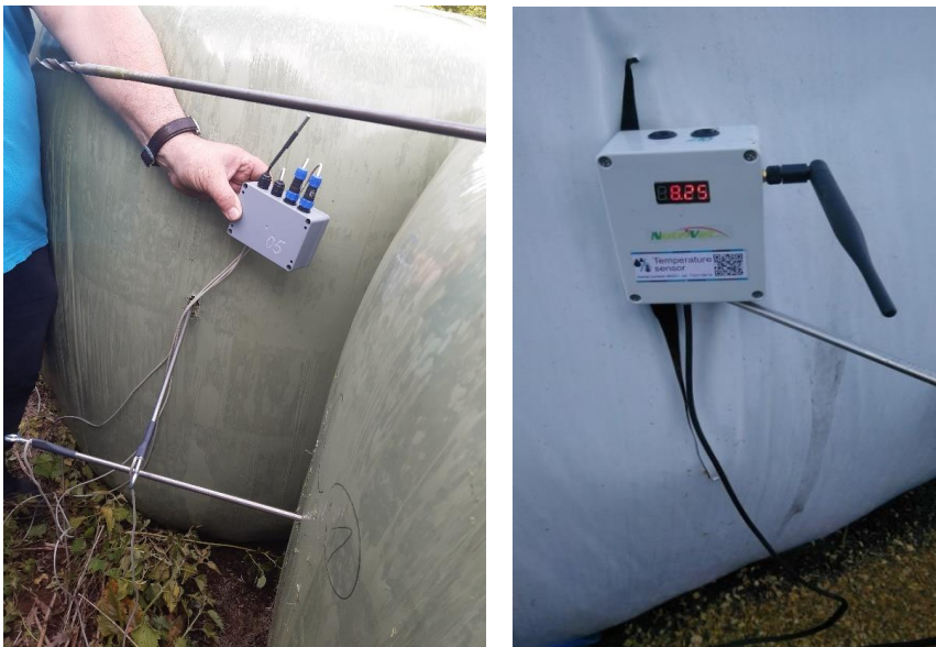
Obr. 7: Tyčové teploměry a datalogger na balících (vlevo) a na silážním vaku (vpravo)
