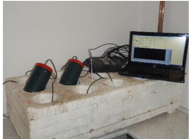
Obr. 6: Správná praxe ochrany siláže před aerobní degradací v silážním žlabu (vlevo), aerobní stabilita, měřená teplotními senzory v laboratoři (vpravo)
